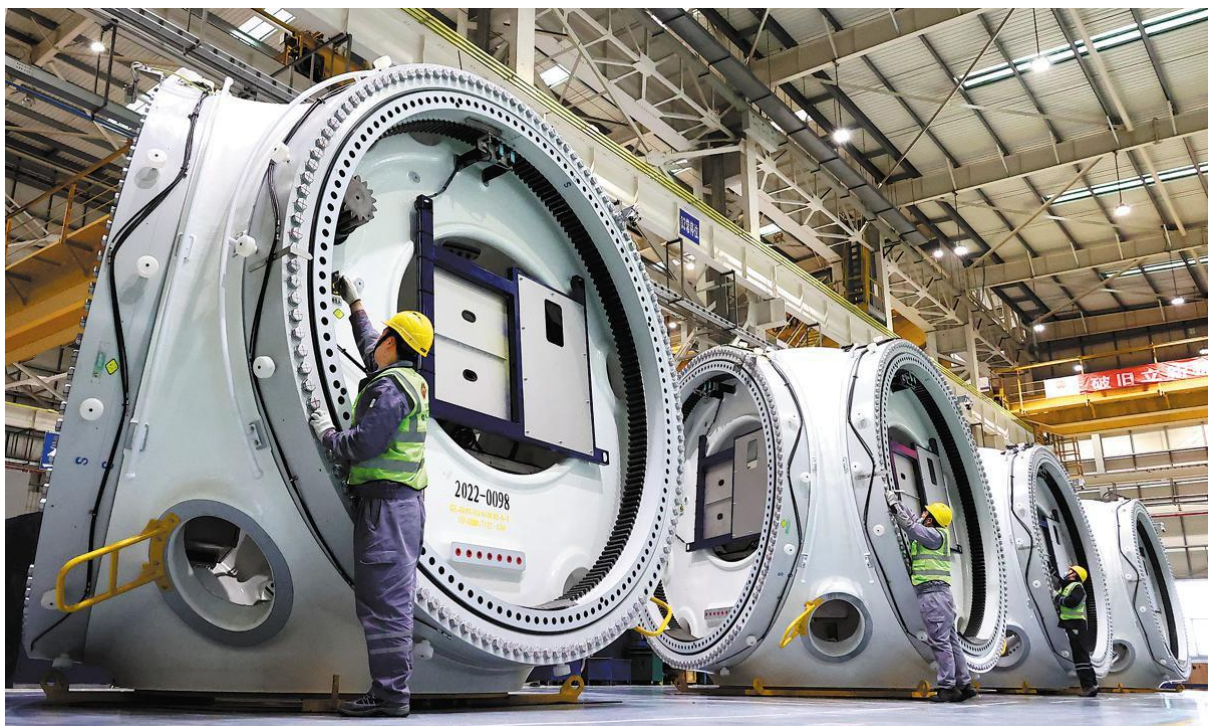
Trabajadores ensamblan ruedas de aerogeneradores en una fábrica en la Zona de Desarrollo Económico y Tecnológico de Lianyungang, Jiangsu, China.
